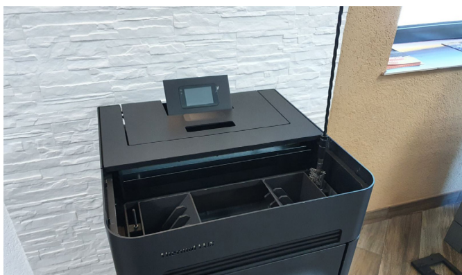
Kanali dimnih plinova
