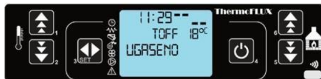
Prikaz displeja regulacije kotla Pelling u ugašenom stanju, (kotlovska temp.)
